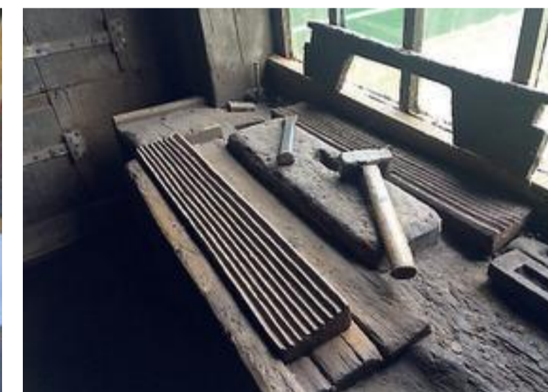
De messen van de maalkak werden met hamer en beitel geslepen. FOTO HMC
