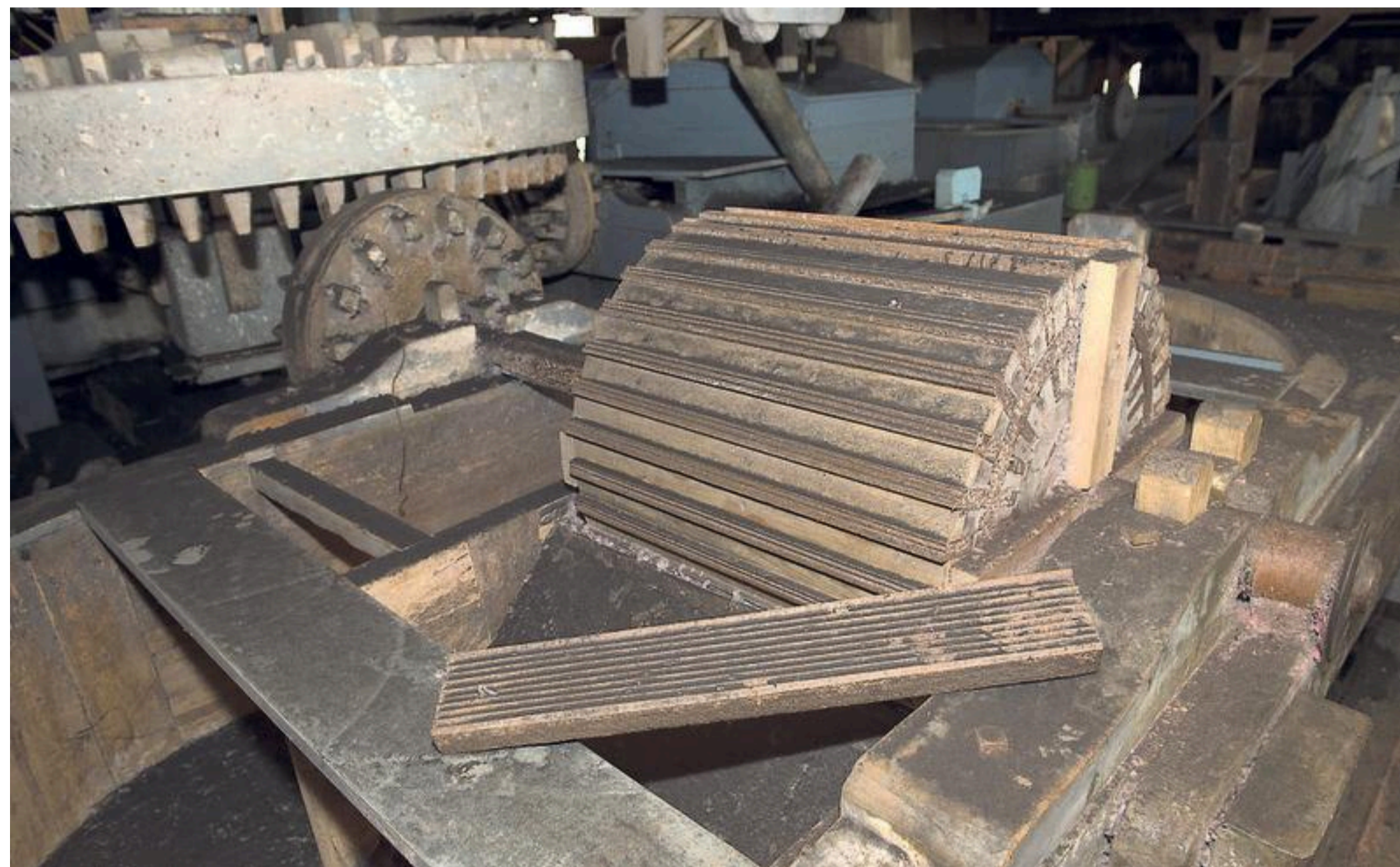
De maalkak, waarin oude vodden werden fijngemalen tussen een draaiende rol en de bodem van de bak. Papiermolen De Schoolmeester in Westzaan werkt er nog steeds mee.
